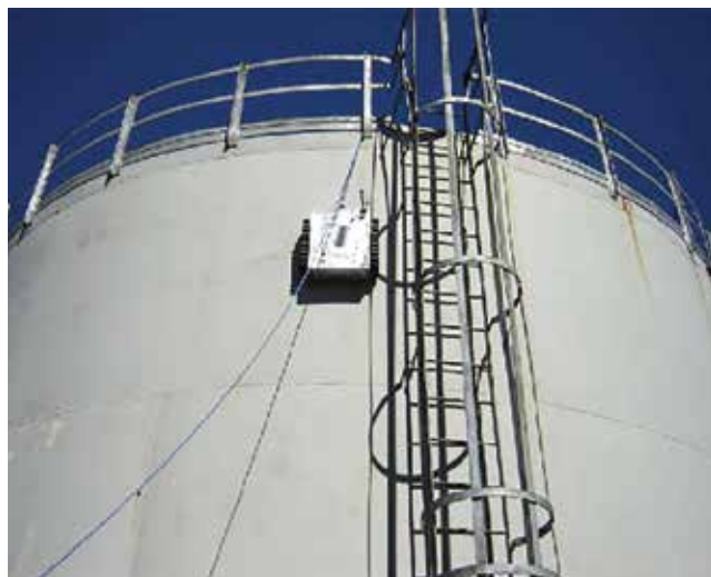
Hình 5. Thử nghiệm robot phát hiện vết nứt trên thân bồn chứa nhiên liệu hình trụ đứng [4].
